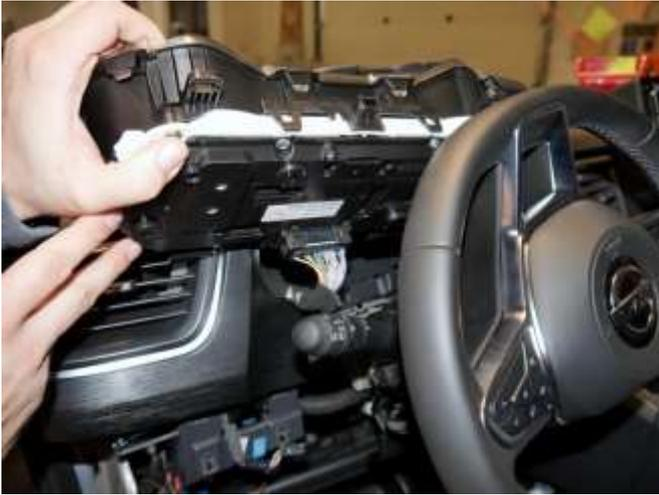
Der benötigte CAN-Bus befindet sich am Stecker hinter dem Kombiinstrument.
