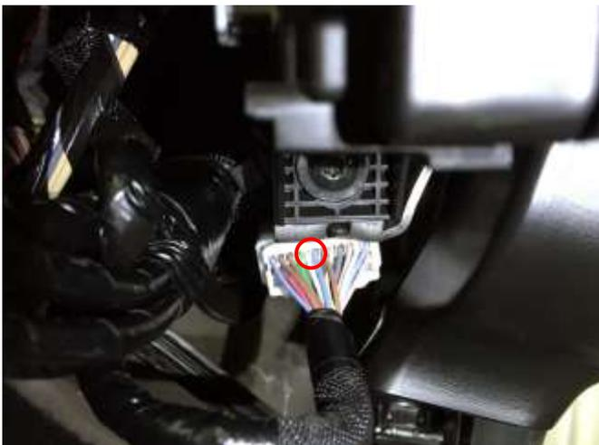
Der benötigte CAN-Bus-Abgriff befindet sich am weißen Kabelbaumstecker unter dem BCM.
