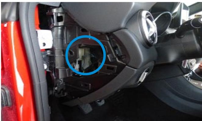
Der CAN-Bus befindet sich an dem markierten Stecker am Kombiinstrument:
