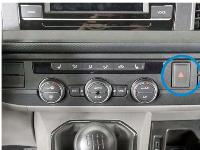
Der Abgriff für das Warnblinkersignal erfolgt am weißen, 6-poligen Stecker hinter der Warnblinkertaste.
