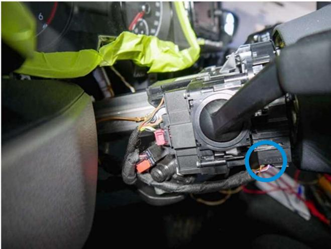
Falls die Hupen-Ansteuerung via CAN nicht funktioniert, kann der analoge Abgriff für das Hupensignal am schwarzen, 16-poligen Stecker an der Wickelfeder zum Lenkrad erfolgen. Um diesen zu erreichen, muss die Verkleidung um den Lenkstock abgenommen werden.
