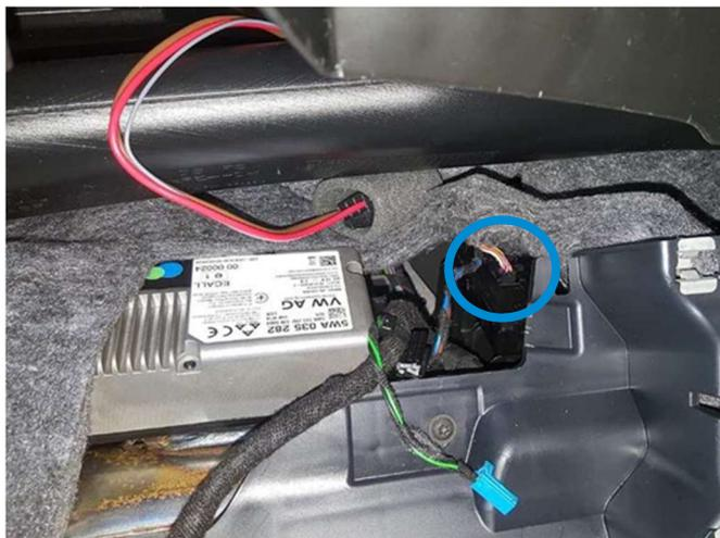
Der CAN-Bus befindet sich am schwarzen, 20-poligen Stecker am Gateway.
