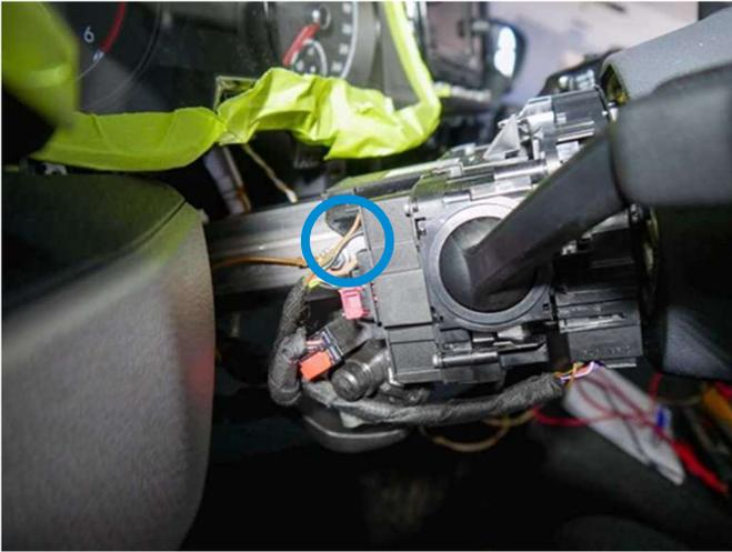
Der Abgriff für das Fernlichtsignal erfolgt am schwarzen, 16-poligen Stecker am Lenkstock. Um diesen zu erreichen, muss die Verkleidung um den Lenkstock abgenommen werden.
