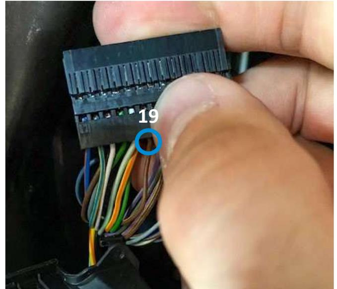
Das Warnblinkersignal befindet sich an Pin 19 (braun-gelb) des 52 poligen Steckers.
