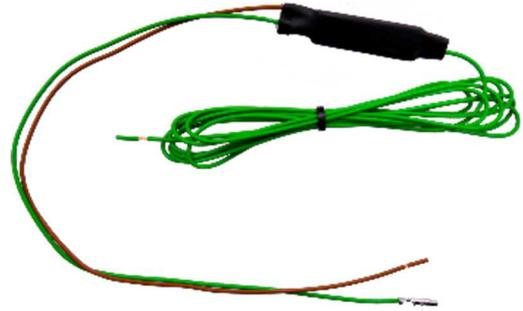
Bei Hupe verwenden: MUTE PCB Taxialarm Pin 8.8 Umsetzung 12V -> Masse
