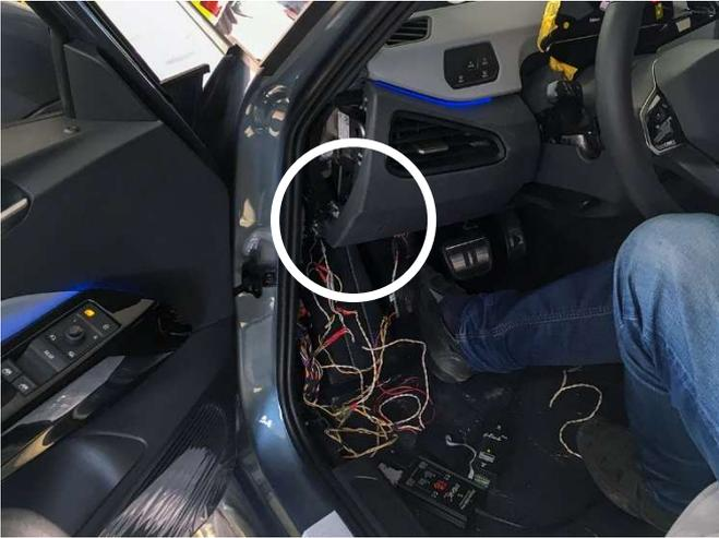
Der benötigte CAN-Bus befindet sich am linken, schwarzen Stecker über den Pedalen.
