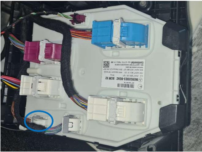
Der benötigte CAN-Bus befindet sich am markierten Stecker am SAM. Dieses ist hinter der Fußablage auf der Beifahrerseite.
