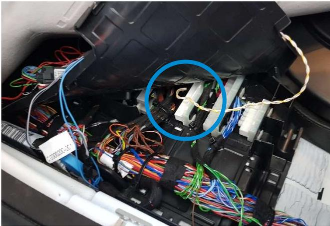
Der benötigte CAN-Bus befindet sich am markierten Stecker unterhalb des Teppichs der Fahrerseite am CAN-Verteiler.
