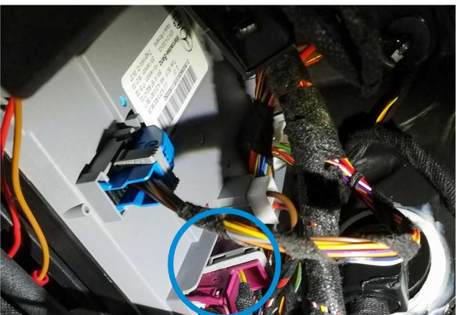
Das benötigte Hupensignal befindet sich am BCM. Dieses ist an der A-Säule der Fahrerseite zu finden.
