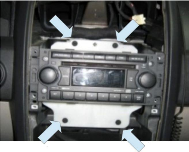
Bauen Sie das originale Radio aus. Dazu müssen vier Schrauben entfernt werden.
