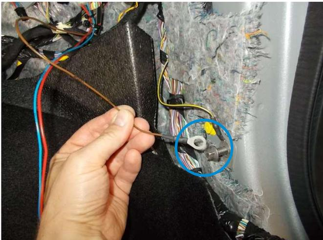
Die Masse wird an der A-Säule abgegriffen.
