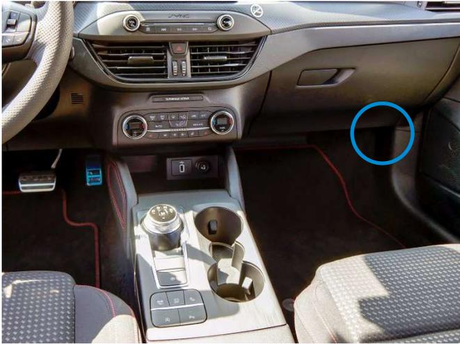
Der benötigte CAN-Bus befindet sich im Beifahrerfußraum, nahe des BCM an der Spritzwand.
