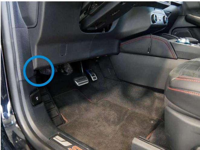
Der benötigte CAN-Bus befindet sich hinter der OBD II Buchse am Gateway-Stecker.
