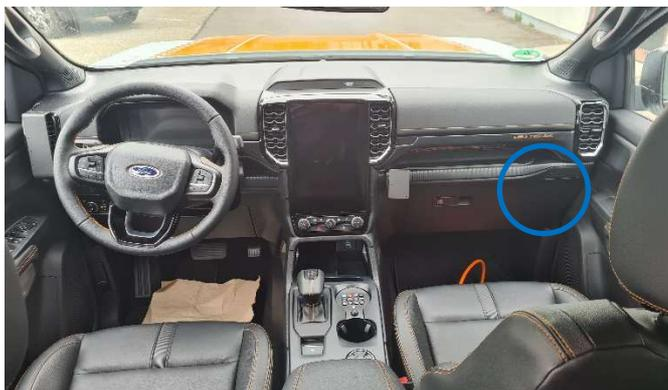
Der CAN-Bus Abgriff befindet sich im Beifahrerfußraum hinter dem Handschuhfach.
