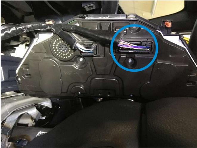
Der benötigte CAN-Bus befindet sich am schwarzen, 40-poligen Stecker hinter dem Kombiinstrument.
