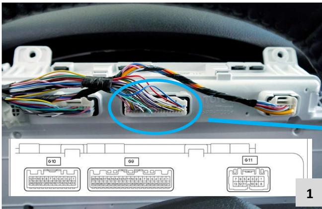
Der Abgriff befindet sich auf der Rückseite des Kombiinstrumentes.
