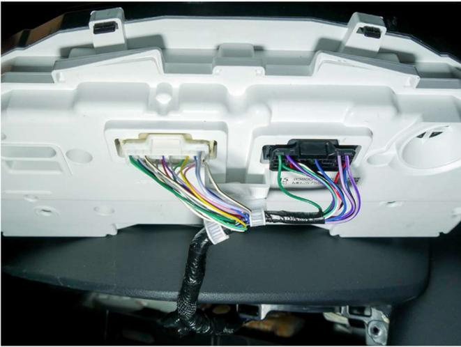
Der benötigte CAN-Bus befindet sich am weißen Stecker. Das analoge Blinkersignal kann am schwarzen Stecker abgegriffen werden, da das auf dem CAN-Bus liegende Blinkersignal stetig ausgegeben wird.
