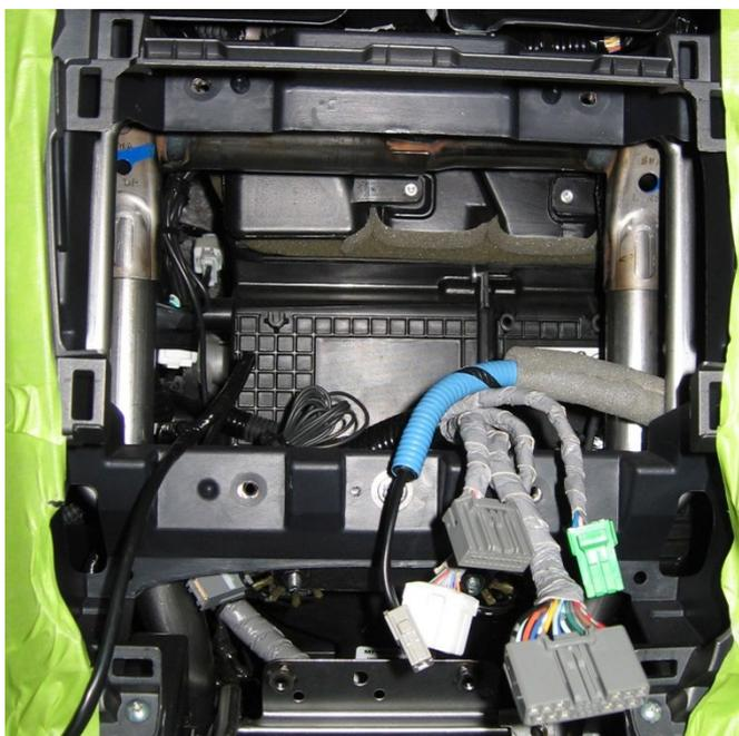
Bauen Sie das originale Radio aus. Hierfür müssen vier Schrauben gelöst werden.
