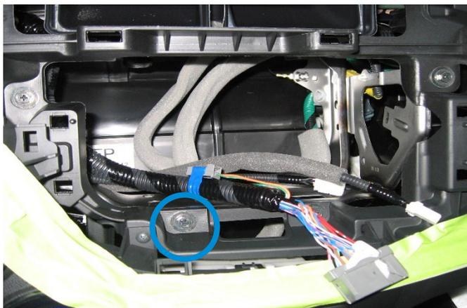
Bauen Sie das originale Radio aus. Hierfür muss eine Schraube gelöst werden.
