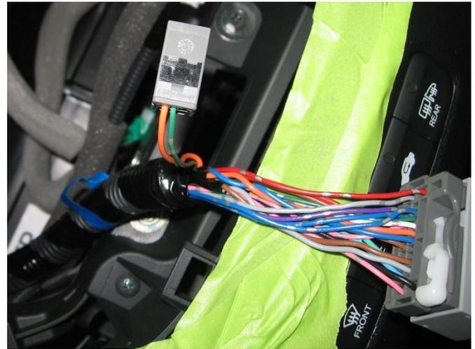
Feststellbremse: Pin 1, orange
