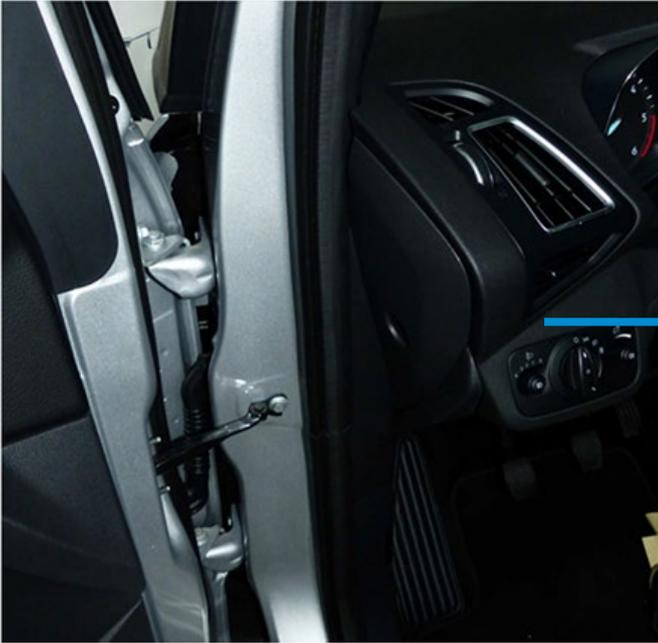
Der OBD-Stecker befindet sich unter dem Lichtschalter auf der Fahrerseite. OBD-Buchse freilegen.
