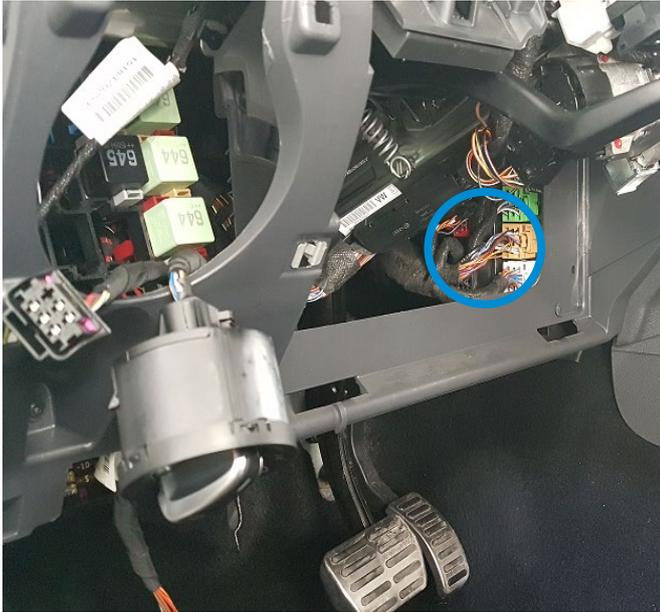
Die Zentralelektrik befindet sich im Fahrerfußraum rechts.
