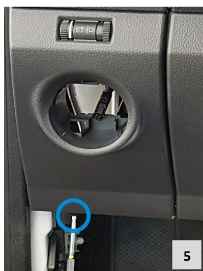
Schraube lösen und Verkleidung
