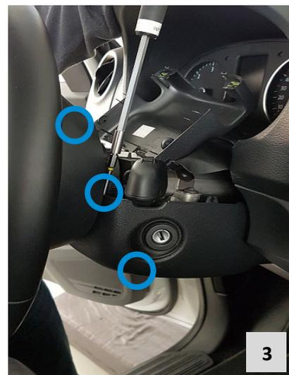
Markierte Schrauben lösen.
