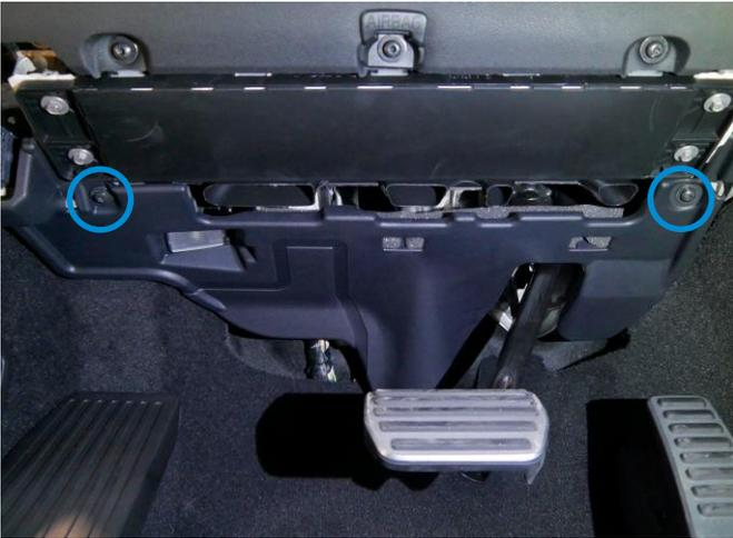
Der benötigte CAN-Bus befindet sich am VCU1 im Fahrerfußraum. Um das VCU1 zu erreichen, müssen die markierten Schrauben gelöst werden.
