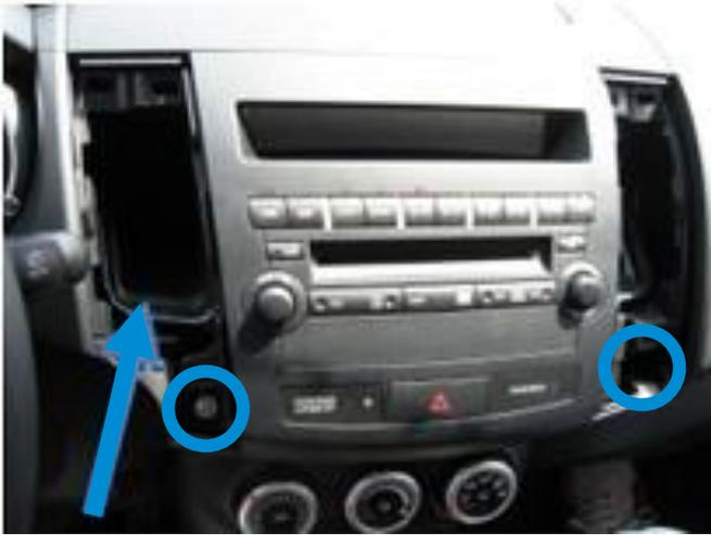
Der benötigte CAN-Bus ist hinter dem Autoradio am Radiostecker zu finden.
