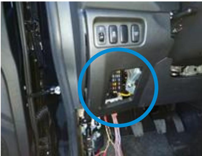
Der benötigte CAN-Bus ist am BCM im Fahrerfußraum links zu finden. Um das BCM zu erreichen, muss die Plastikabdeckung entfernt werden.
