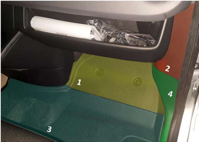
Um an den benötigten CAN zu gelangen, müssen folgende Verkleidungen in angegebener Reihenfolge entfernt werden. Das Steuergerät "elektronisches Zündschloss" befindet sich rechts.
