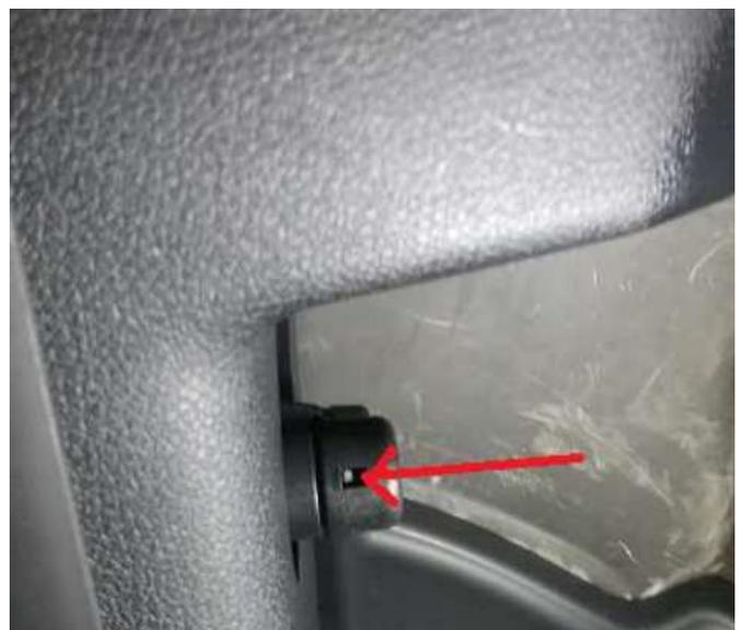
Abdeckungen im Fahrerfußraum entfernen (ähnlich wie oben beschrieben) und Haubenöffnungsgriff entfernen. Dazu markierte Nase eindrücken und Hebel seitlich abziehen.
