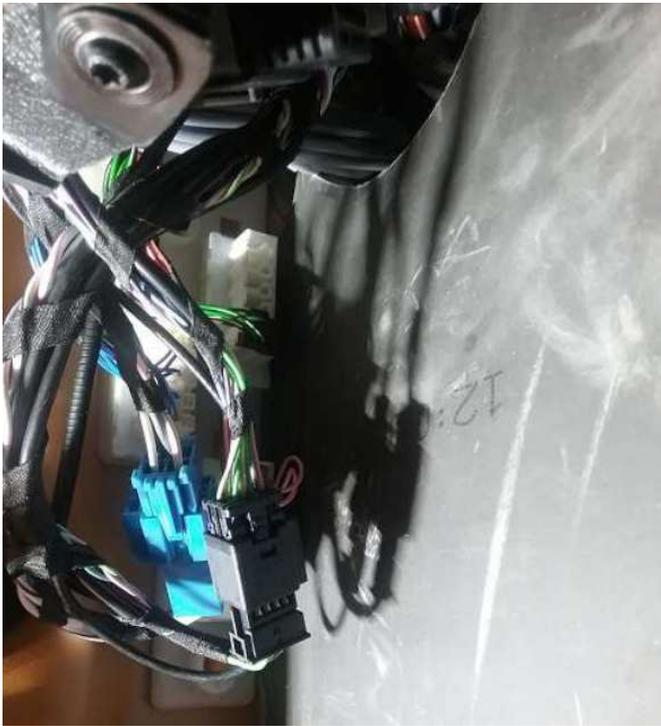
Hinter der zuvor entfernten Verkleidung ist der CAN-Verteiler zu finden.
